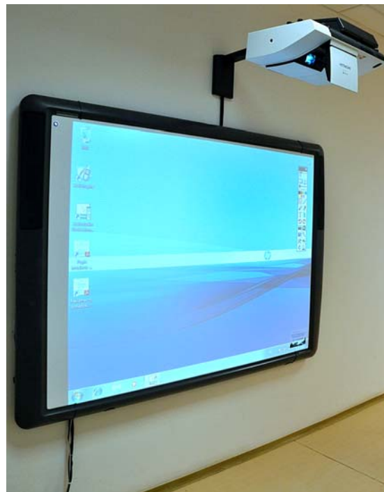
Celková inštalácia interaktívnej tabule a projektora na nástennom ramene
