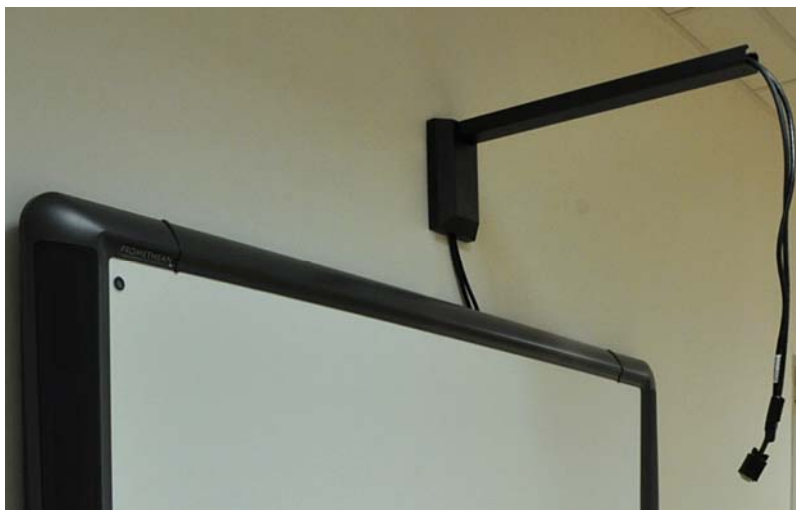
Inštalácia základne nástenného ramena a káblov VGA a 230V
